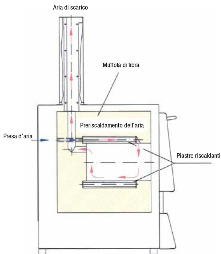
Principio di alimentazione e scarico dell'aria
