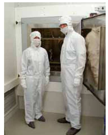
Forno a convezione N 250/65 HAC con camera bianca. Per il caricamento del forno la porta si trova nella camera bianca, classe 100, la camera del forno si trova nella camera grigia posteriore.
